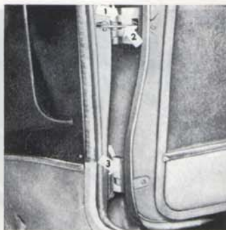
Bild 55. Dörrgångjärn 1 och 2. Gångjärn (tunn olja) 2. Dörrstopp (paraffin)
