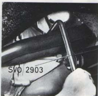
Bild 24. Demontering av oljerenare
